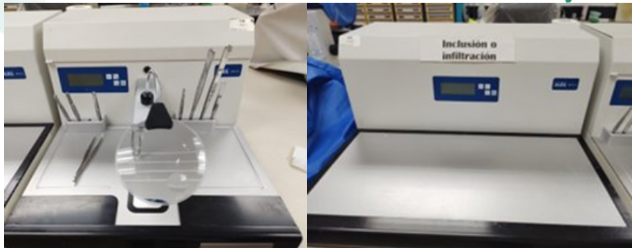
Figura 4. a) Inclusión b) Plato frío
